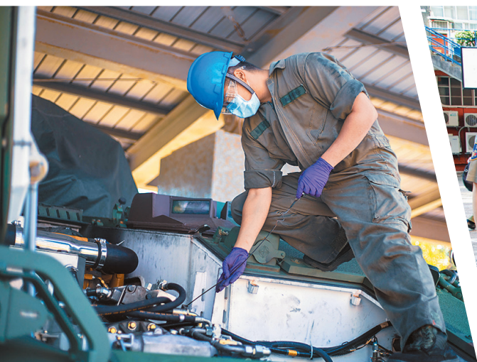
圖／官兵檢查裝步戰鬥車變速箱油。
